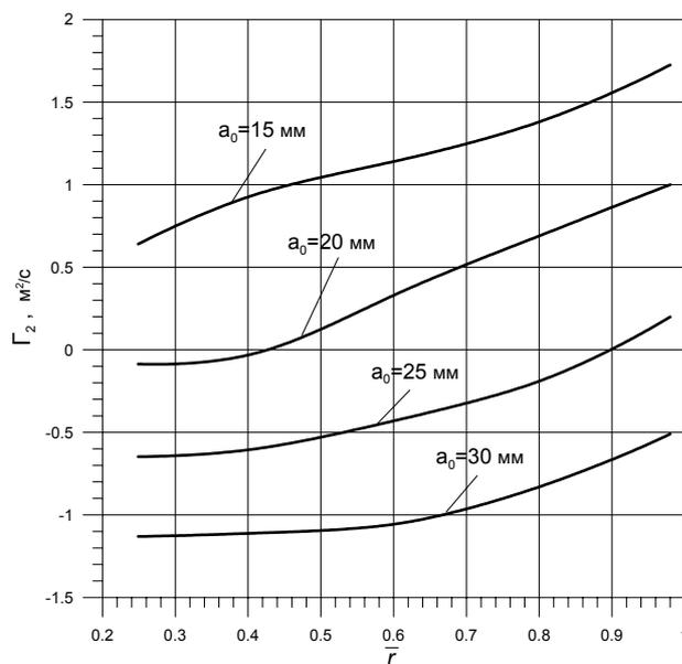
Рис. 3 – Циркуляция потока за рабочим колесом модельной гидротурбины РО-170
