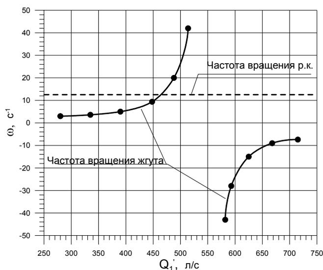
Рис. 5 – Частота вращения вихревого жгута в отсасывающей трубе модельной гидротурбины РО-170 при  $n_1' = 63 \text{ мин}^{-1}$
