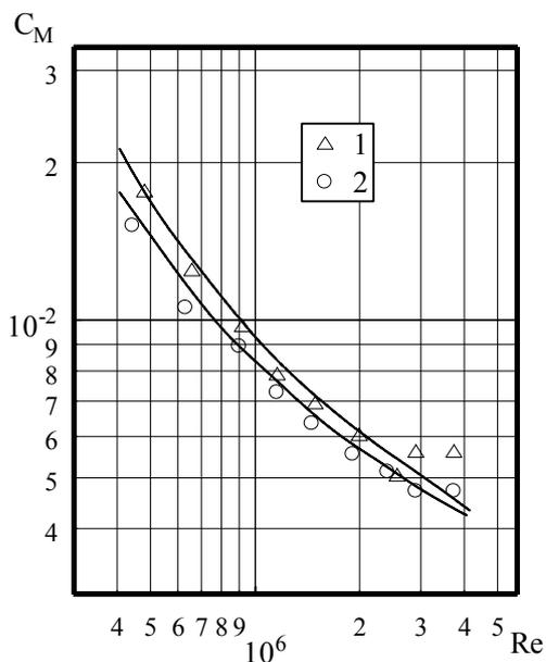
Рис. 3 – Зависимость коэффициента сопротивления от числа Re при  $S/R = 0,06$  и  $C_W = 4,7 \cdot 10^4$ ,
