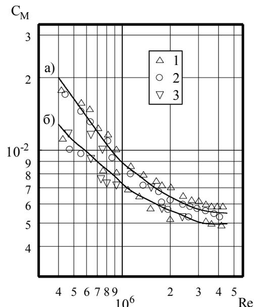
Рис. 4 – Зависимость коэффициента сопротивления от числа Re при  $S_0/R = 0,0067$ ,
