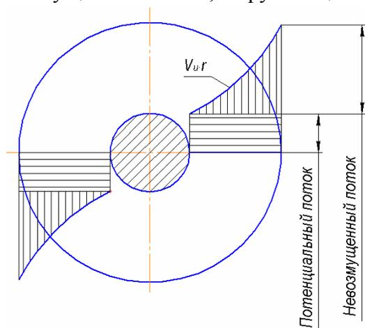
Рис. 1 – Эпюра изменения момента скорости за рабочим колесом
