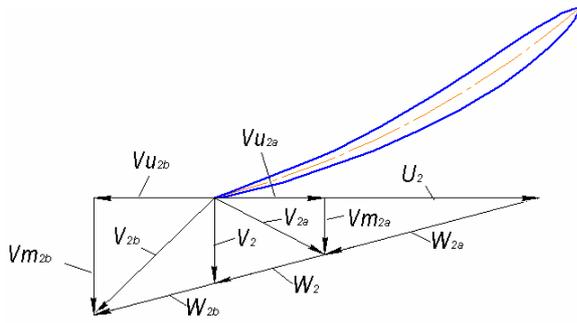
Рис. 2 – Треугольники скоростей на выходе из рабочего колеса
