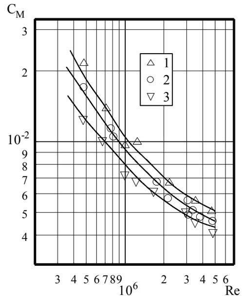
Рис. 2 – Зависимость коэффициента сопротивления от числа Re при  $S/R = 0,06$  и  $S_0/R = 0,0033$ ,
